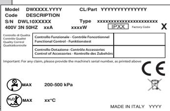
In caso di sostituzione della scheda elettronica è necessario inizializzare la nuova scheda. Inserire il codice di fabbrica evidenziato nell'etichetta posta nel porta-componenti all'interno del sottoporta.
