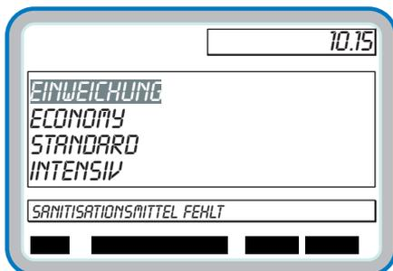
Wenn auf dem Display **SANITISATIONSMITTEL FEHLT** erscheint, ist das Desinfektionsmittel aufgebraucht. Die Meldung wird auch durch ein akustisches Signal "Buzzer" gegeben, welches einige Minuten lang erscheint und dann erlischt.
