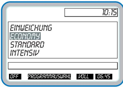
Um den gewünschten Spülgang zu wählen drücken Sie die Tasten **C** (senken) oder **D** (erhöhen) oder halten Sie die Taste **Start A** gedrückt.
