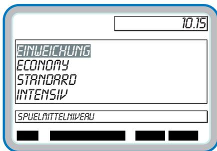
Wenn auf dem Display **SPÜLMITTELNIVEAU** erscheint, ist das Spülmittel aufgebraucht. Die Meldung wird auch durch ein akustisches Signal "Buzzer" gegeben, welches einige Minuten lang erscheint und dann erlischt.
