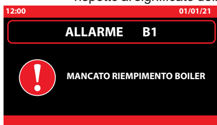
Esempio finestra di allarme.
